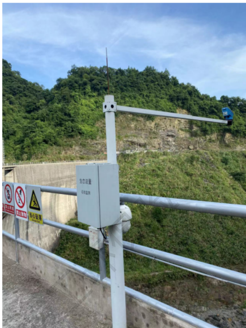
图 4-1 生态流量在线监测装置
